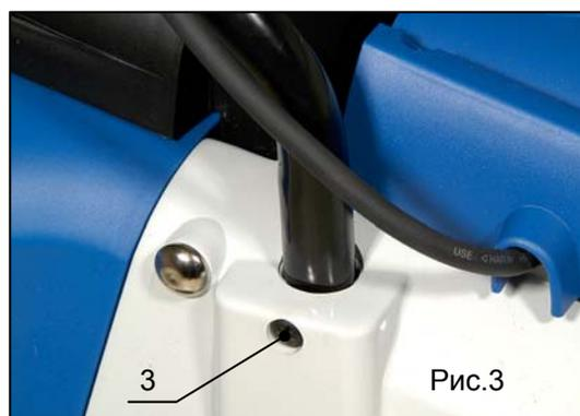
Для установки необходимо обе нижние части (поз.1, рис.2) рукоятки вставить в два отверстия (поз.2, рис.2) на корпусе газонокосилки и закрепить их с помощью саморезов (поз.3, рис.3). Затем установите верхнюю часть рукоятки с выключателем. Крепление выполняйте при помощи двух пластиковых гаек (поз.4, рис.4).
