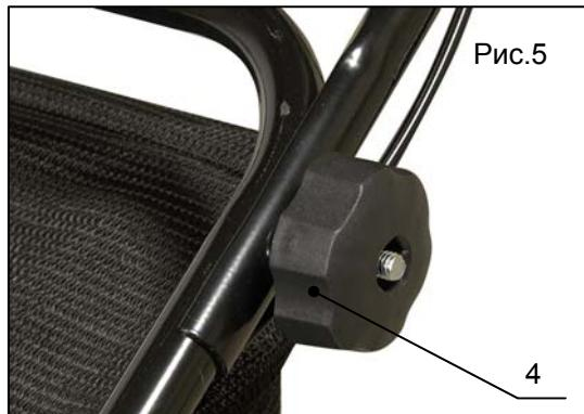
Для установки необходимо обе нижние части (поз.1, рис.4) рукоятки вставить в два паза (поз.2, рис.4) на корпусе газонокосилки и закрепить их с помощью комплекта винтов и пластиковых гаек (поз.3, рис.4). Затем установите верхнюю часть рукоятки с рычагами газа и привода. Крепление выполняйте при помощи комплекта пластиковых гаек и болтов (поз.4, рис.5). Установку выполните, как указано на рисунке 5.
